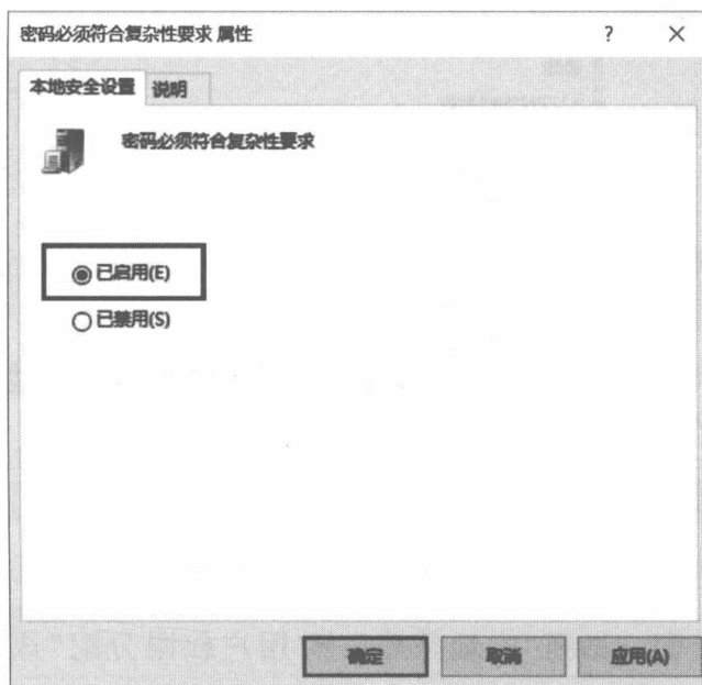
图 2-81 启用“密码必须符合复杂性要求”功能
