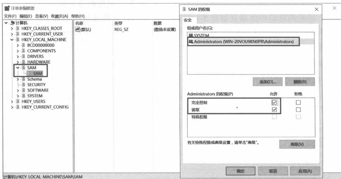
图 2-105 设置 SAM 完全控制权限
