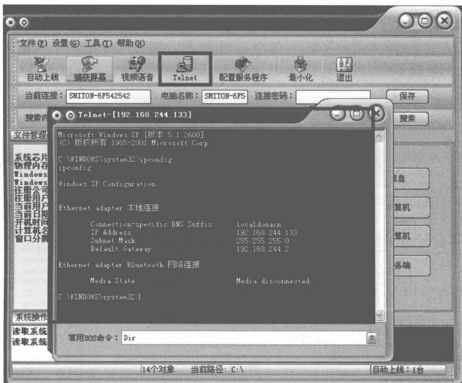
图 4-22 通过 Telnet 对靶机进行控制
