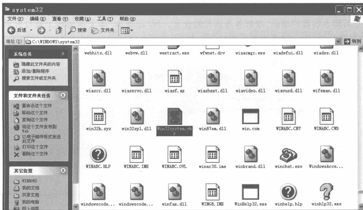
图 4-9 Windows/system32 目录下出现不明来源脚本文件
