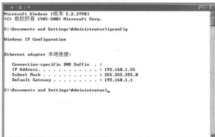
图 5-70 使用 ipconfig 命令查看靶机的 IP 地址
