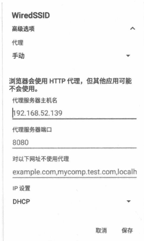
图 7-33 设置代理服务器主机名和代理服务器端口
