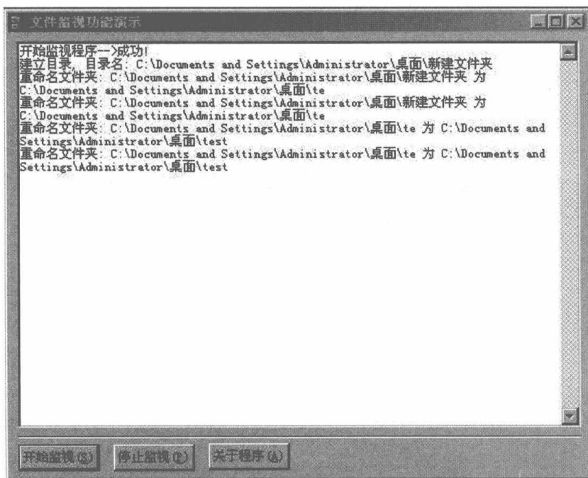
图 4-40 FileChangeNotify 记录下了文件夹名称修改和删除的信息
