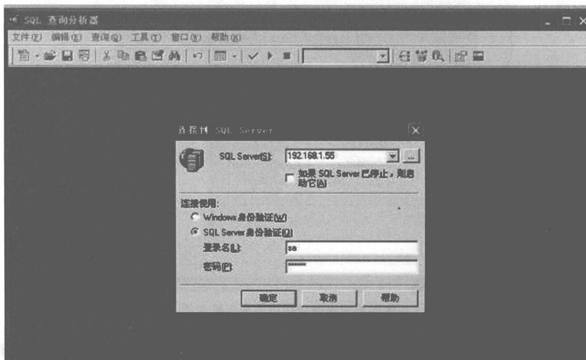
图 5-81 使用查询分析器连接 MS SQL 数据库
