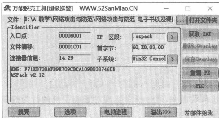
图 7-5 使用万能脱壳工具检测 test.exe 程序
