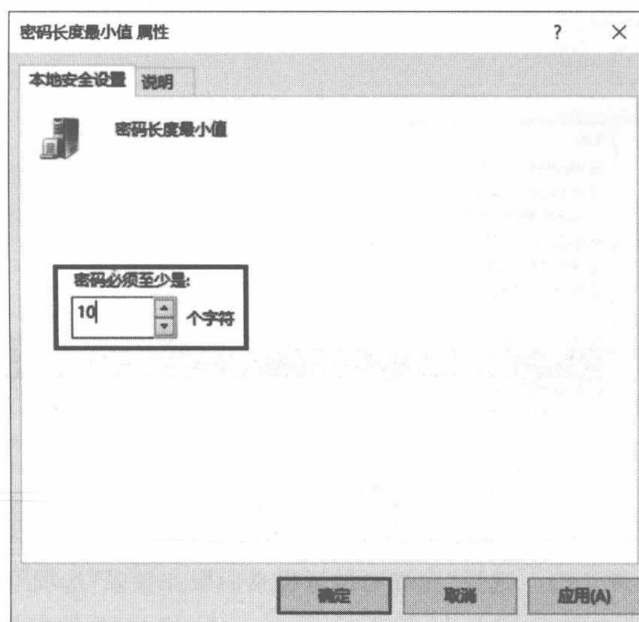
图 2-82 设置“密码长度最小值”
