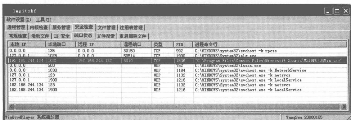
图 4-34 使用 Wsyscheck 工具检查端口状态
